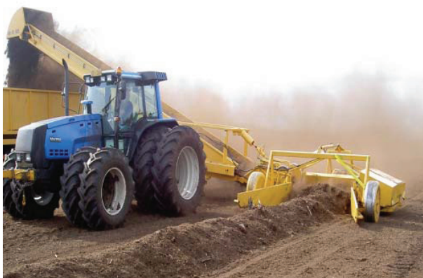
Сбор торфа в валках и погрузка на транспорт
