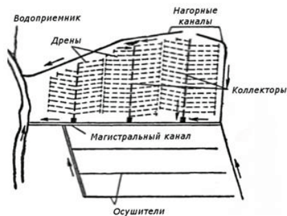
Схема осушительной системы, состоящей из закрытого дренажа и открытых каналов
