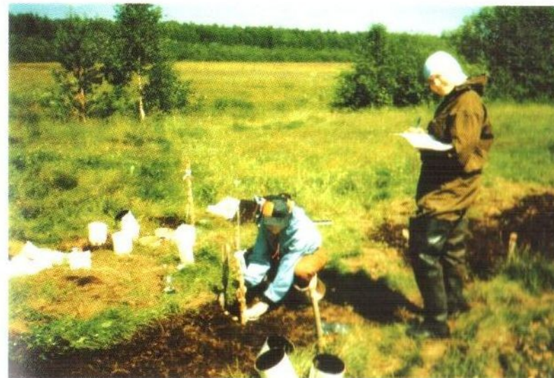
Определение интенсивности выделения \text{CO}_2 по методу Штанова
