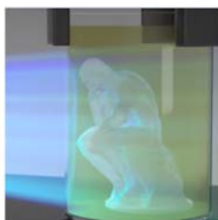
Рис. 7. Объект, сформированный CAL технологией
